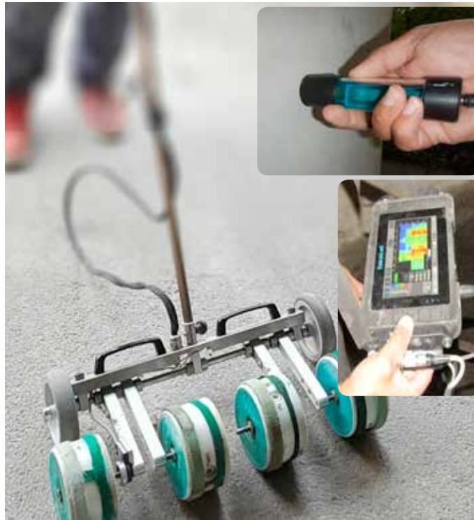
Foto: Radelektrode für große Flächen Foto oben rechts: Punktelektrode für kleine Flächen Foto mitte rechts: Messgerät mit farblicher Messwertdarstellung
